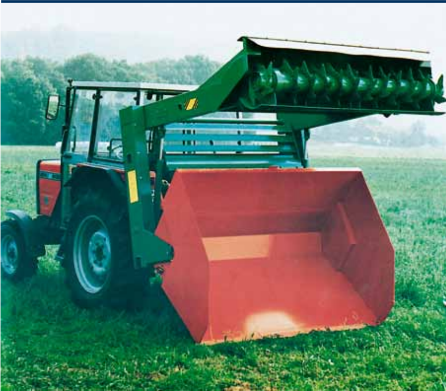
Fräse am Schlepper mit Fräsarm und Segmentblech zum Auskippen
