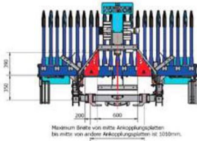
**Beobachten Sie während der Anbau die Höhe von die Federung und die Reifenregeldruckanlage. Der Stützzlast wird sich auch ändern!**
