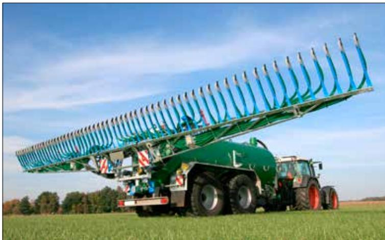
Der Speedy kann einfach und schnell an neue und gebrauchte Güllefässer mit Schleppschuhvorbereitung montiert werden. Die neu entwickelte Steuerung für diesen Verteiler erfordert nur ein doppelt wirkendes Steuergerät am Schlepper. Alle Funktionen wie Ein- und Ausklappen, Heben und Senken, Antrieb der Schneidverteilköpfe und der Schieber / Dreiwegehahn werden automatisch in Folge geschaltet.
