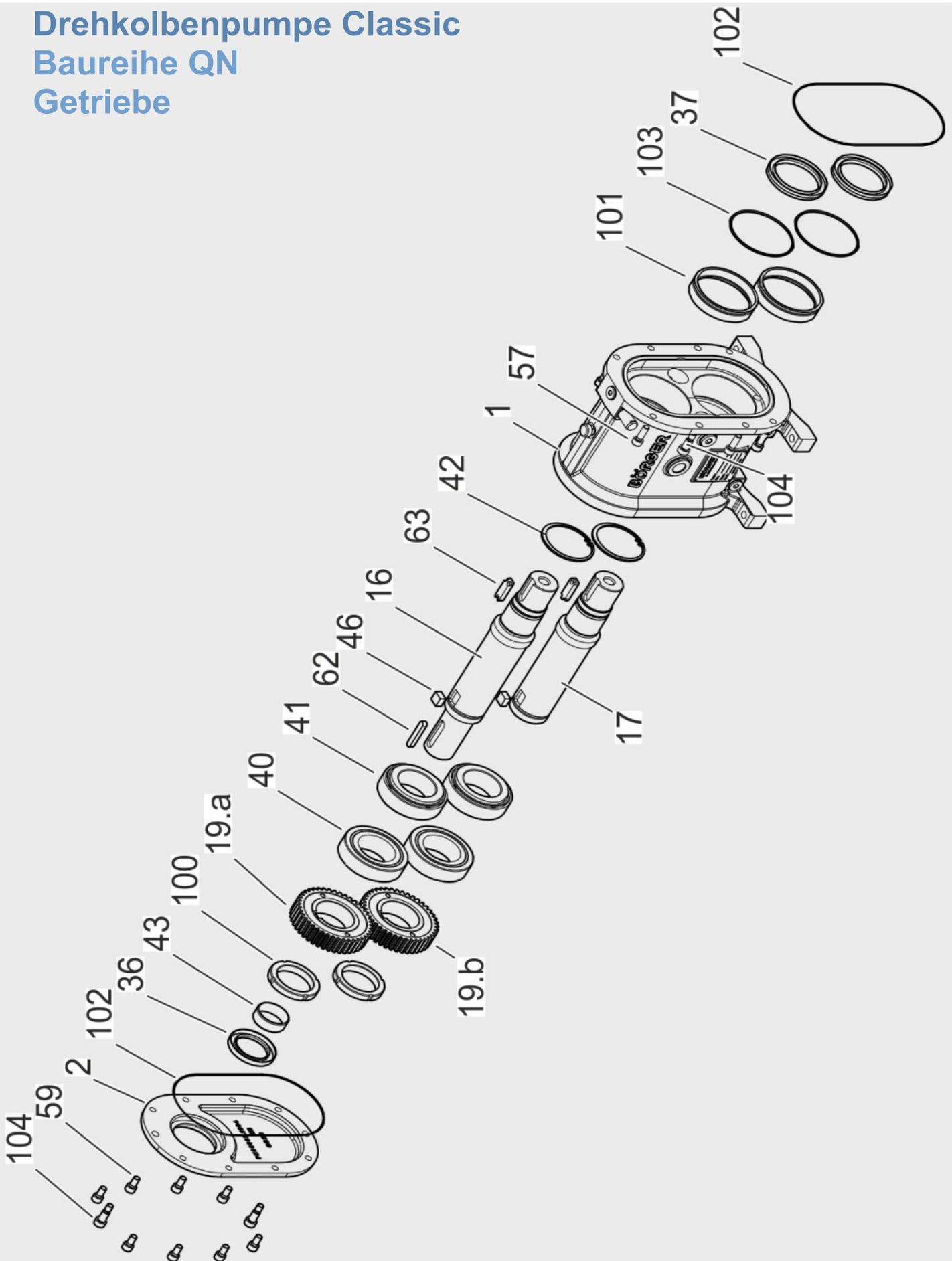
Börger Drehkolbenpumpe Classic Baureihe QN Getriebe
